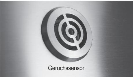
Dieses Gerät verfügt über einen „Geruchssensor“. Dieser reagiert auf Wasserdampf und Braten- bzw. Kochdünste (Wrasen) und nimmt die Dunstabzughaube bei Bedarf selbsttätig in Betrieb. Hierbei erfolgt eine vollautomatische Steuerung der Lüfterleistung, abhängig von der Wrasenintensität.
