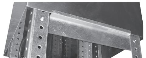
Nachdem das erste Halblech befestigt wurde, muss noch das zweite Halblech in der gleichen Weise an der gegenüberliegenden Seite befestigt werden.
