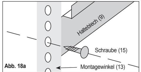
Abb. 18b: Die Halbleche werden von außen an die Montagewinkel verschraubt.
