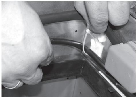
Neben der grauen Anschlussbox für das Bedienteil befindet sich eine weitere Anschlussbox. Sie enthält die Anschlussbuchse für den Geruchssensor.
