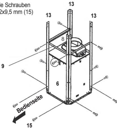
Der Motorblock (6) wird wie folgt an der Deckenplatte (5) befestigt (Abb. 16): Motorblock (6) mit den montierten Montagewinkeln (13) an die befestigte Deckenplatte (5) heben und einsetzen. Zur sicheren Befestigung je 4 Schrauben 4,2x9,5 mm (15) an jeder Ecke der Deckenplatte (5) einsetzen und festziehen (Abb. 16, 17).
